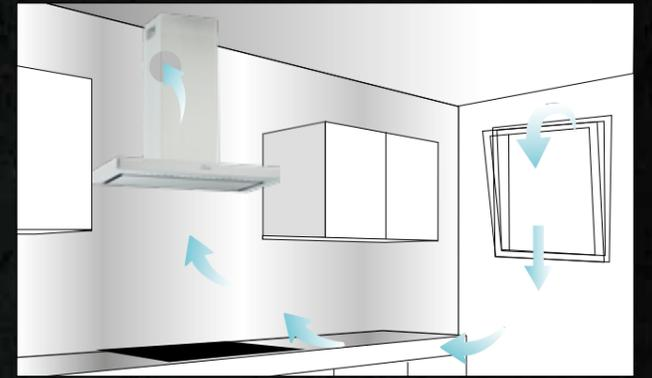
Eine Dunstabzugshaube, die mit Umluft betrieben wird, filtert den vom Lüfter angesaugten Kochdunst und leitet die „gereinigte“ Luft wieder in die Küche zurück.
